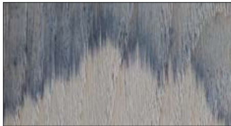
Ausbleichen der Verfärbungen mittels Oxalsäure
